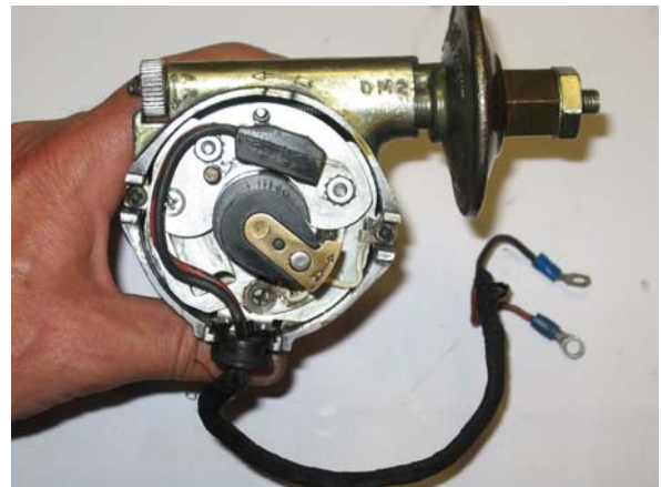
Verteiler mit eingebauter Elektronik
