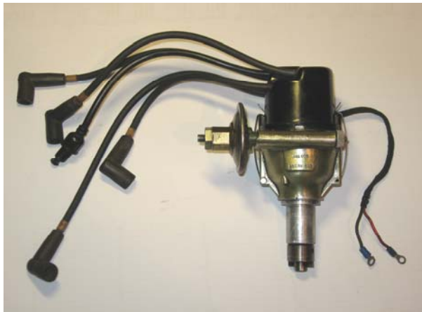
Verteiler nach dem Umbau
